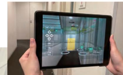
ARによるBIMデータの活用も検討している。ARは現実の風景にバーチャルの視覚情報を重ね合わせて表示する技術で、デバイスを通じて現実的空間上にBIMモデルを重ね合わせて見ることができる。天井裏などの隠蔽設備の可視化やBIM空間上にピンを立てて情報共有を行うことができる
