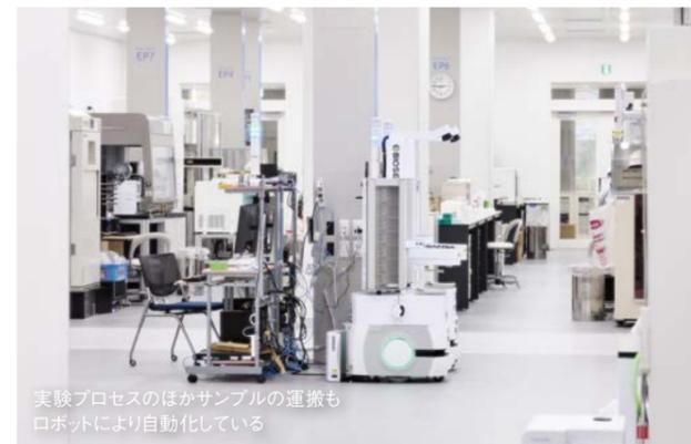
実験プロセスのほかサンプルの運搬もロボットにより自動化している
