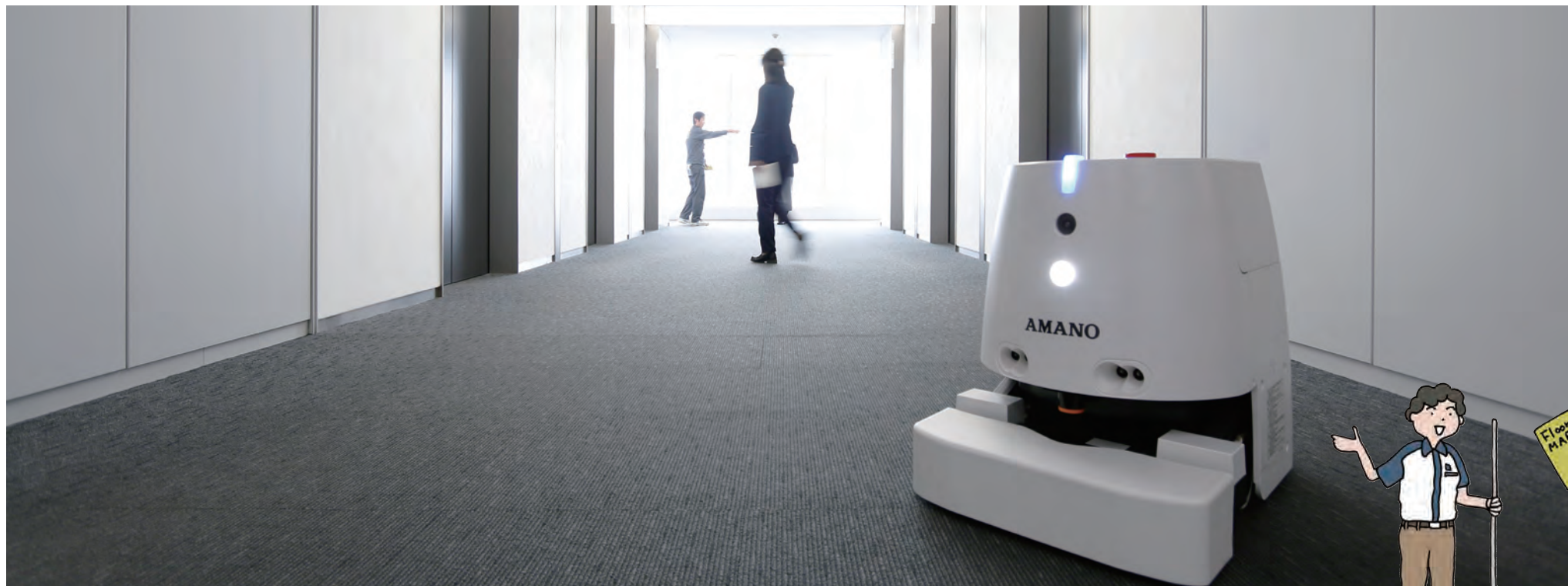
タブレットに空間の形状を登録し、実際にロボットが掃除した範囲も記録していく
