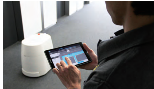
タブレットに空間の形状を登録し、実際にロボットが掃除した範囲も記録していく
