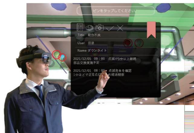
iPad や iPhone で AR を操作し、MR には専用デバイスの HoloLens 2 を用いる
